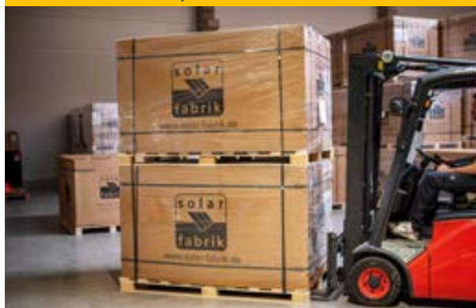
Abbassare il pallet con il carrello elevatore
