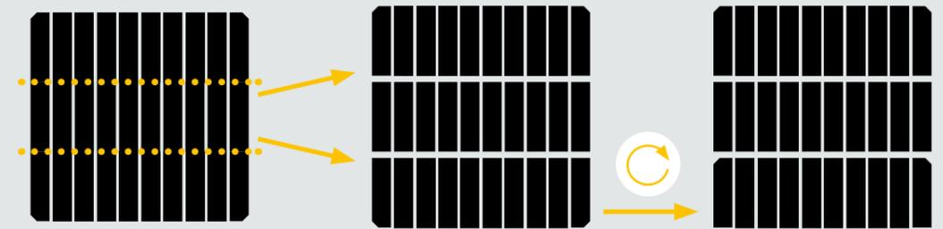
Solarmodule mit halbierten Solarzellen werden als Halbzellenmodule oder Halfcut-Solarmodule bezeichnet. Diese Generation der Solarzellen verfügt über fortschrittliche Eigenschaften.
